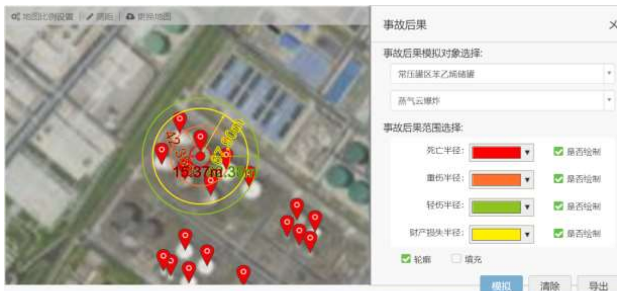
附图 2.2-9 10000m 3 苯乙烯储罐蒸气云爆炸事故后果模拟图
