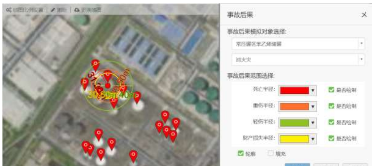
附图 2.2-8 10000m 3 苯乙烯储罐池火灾事故后果模拟图
