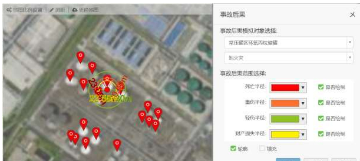
附图 2.2-10 10000m 3 环氧丙烷储罐池火灾事故后果模拟图
